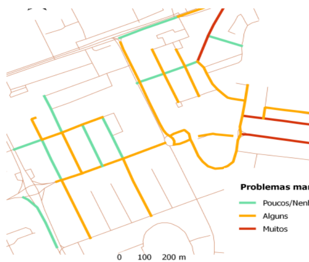
Fig. 2. Resultados de Aplicação-Piloto: Item Problemas na manutenção do piso do passeio - Pontuação por secção (ex.º zona)
